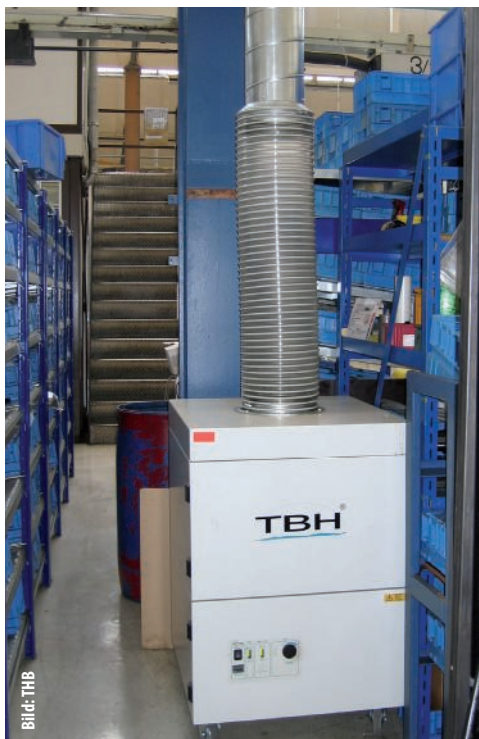
Die Absauganlage sorgt dafür, dass die Schadstoffe aus der Luft entfernt werden und die gereinigte Luft wieder zurückgeführt wird.
