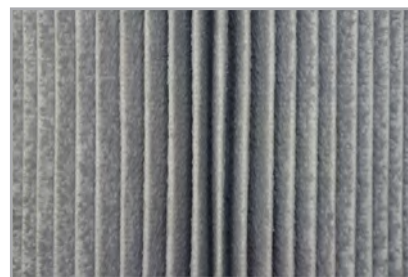
Filterpatrone nach Abreinigung
