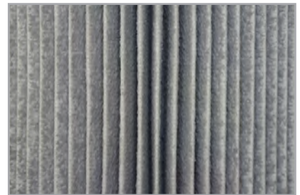
Filterpatrone nach Abreinigung
